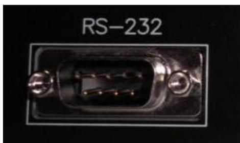
Позволяет подключать устройства поддерживающие интерфейс RS232. Нумерация контактов разъёма приведена на рисунке:
