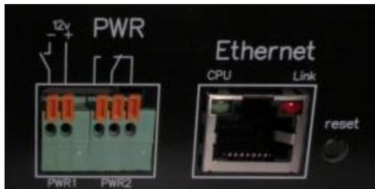
Поддерживает подключение Ethernet jack RJ-45. Содержит 2 встроенных светодиода, CPU и Link.
