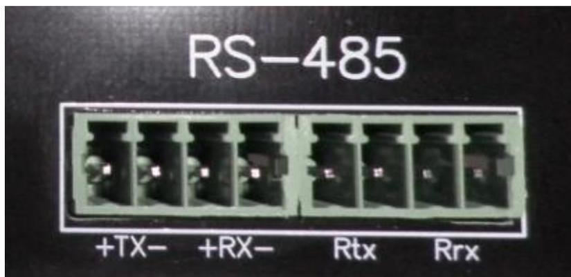
Позволяет подключать устройства поддерживающие интерфейс RS485/RS422.
