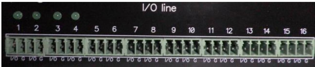
Группа разъёмов к которой подключены 16 IO линий, для подключения датчиков с бинарными выходными состояниями (т.е. с состояниями включено/выключено). Каждая из линий может быть индивидуально сконфигурирована как вход или как выход. Для каждой IO линии выведено 2 клеммы IO и GND.
