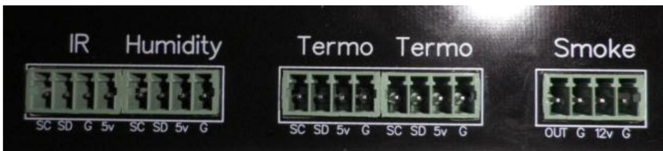
Группа разъёмов, которая используется для подключения датчиков специальных типов. Как правило, это датчики передающие данные по цифровым шинам в своём специальном формате.
