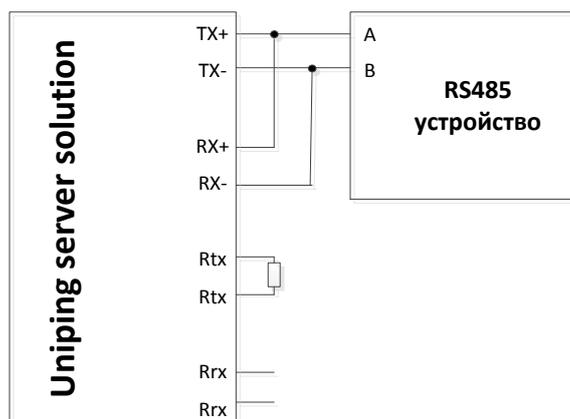
Терминирующий резистор может быть подключен к выводам Rtx при необходимости.
