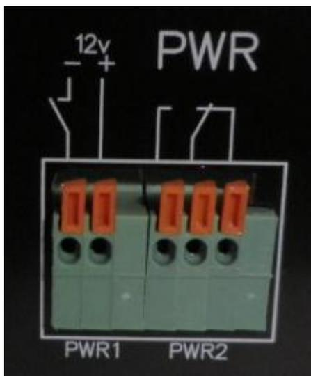
Два канала управления питанием PWR1 и PWR2 выведены в виде клеммников на переднюю панель устройства. Канал PWR1 соединён с внутренним источником напряжения +12В. Канал PWR2 представляет собой контакты реле выведенные непосредственно на клемник. Коммутирующий элементов обоих каналов – низковольтные реле, установленные в корпусе устройства.
