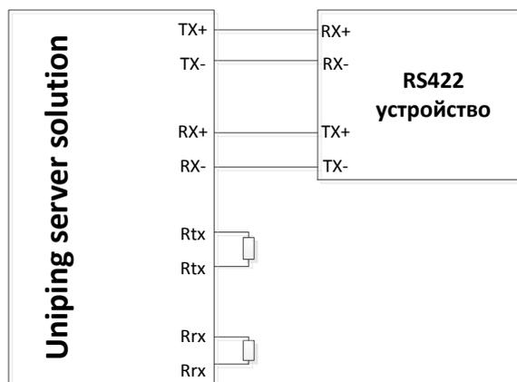
К выводам Rtx и Rrx при необходимости подключаются терминирующие резисторы согласно спецификации интерфейса RS422.
