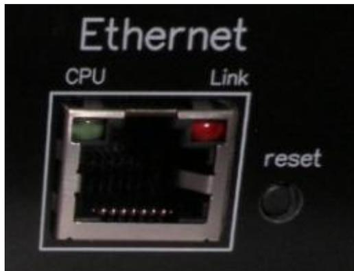
Кнопка **reset** на передней панели устройства предназначена для сброса параметров устройства в значения по умолчанию. Для сброса параметров устройства необходимо нажать кнопку заострённым предметом и удерживать её во время включения питания устройства.
